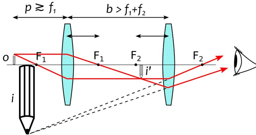
**Figura 2** Representação esquemática de um microscópio composto
