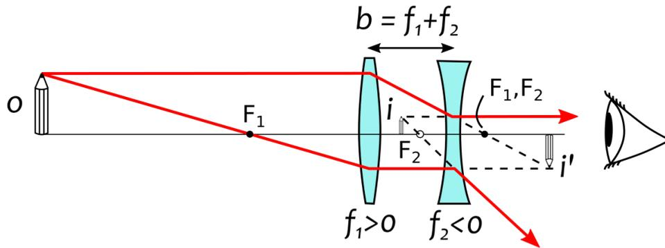
**Figura 5** Representação esquemática da luneta de Galileu
