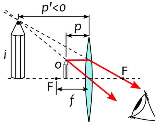
**Figura 1** Representação esquemática de um microscópio simples, mais conhecido como lupa.
