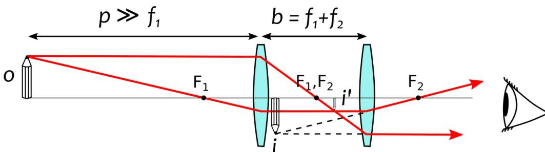
**Figura 4** Representação esquemática de um telescópio
